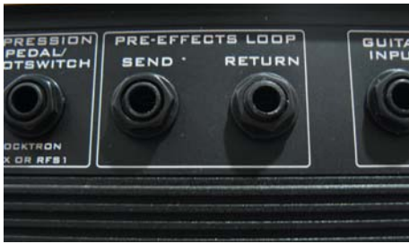
写真1 G300 エフェクト・ループ部 G300には好みのドライブ系エフェクターなどを外部エフェクターとして追加、プログラム可能なエフェクト・ループが装備
