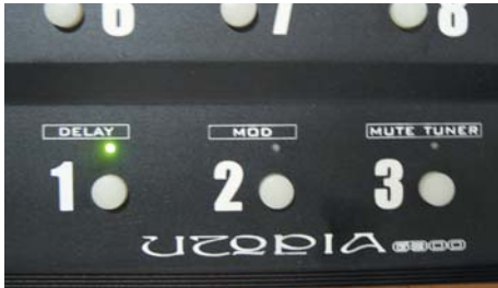
写真2 G300トップ 暗いステージでも確認しやすく蛍光加工されたコントロールしやすいペダル・スイッチ類
